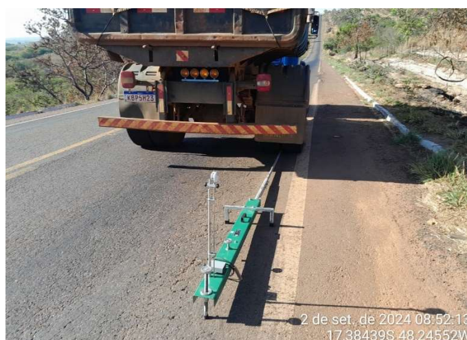
Figura 12: Levantamento Viga Benkelman, GO-330, Urutai-GO
