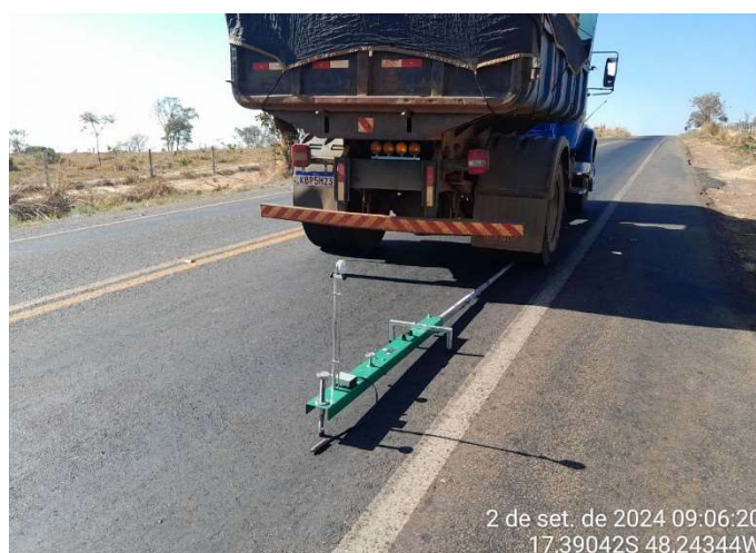
Figura 13: Levantamento Viga Benkelman, GO-330, Urutai-GO
