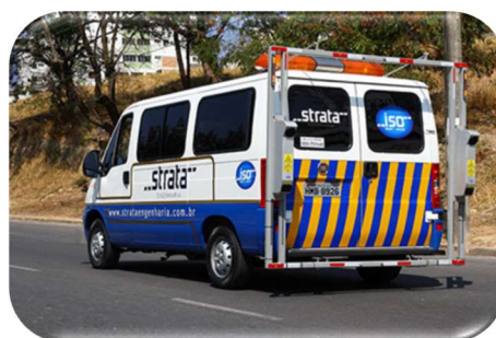
Figura 8: Transverso-perfilógrafo a laser
