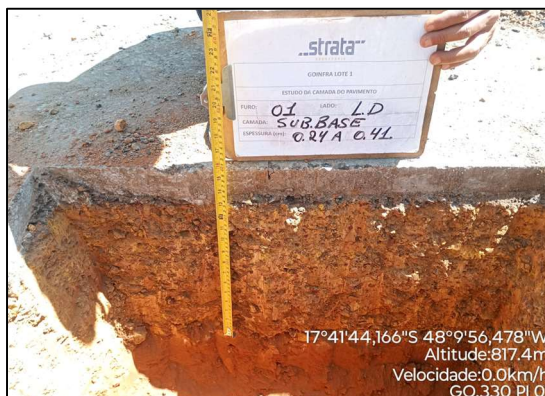
Figura 5 - Identificação das camadas e medição das espessuras.
