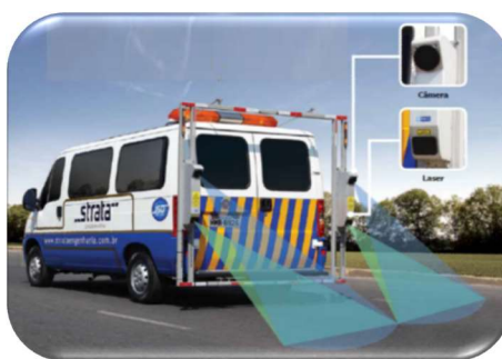
Figura 9: Transverso-perfilógrafo a laser
