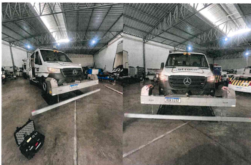
Figura 1 - Perfilógrafo com a barra de calibração fixada a 350 mm
