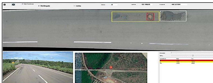
Figura 5: Identificação das patologias, delimitação das áreas comprometidas, mosaico fotográfico, representação geodésica dos locais de ensaio e definição da estrutura.
