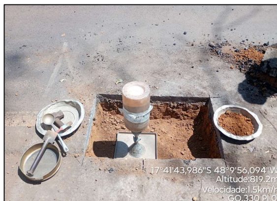
Figura 6 - Execução do ensaio de umidade e densidade in situ.
